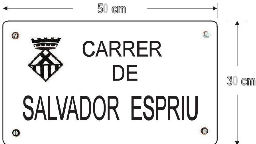
DETALL 1 - Placa de retolament (marbre blanc – gruix de 2 cm)
