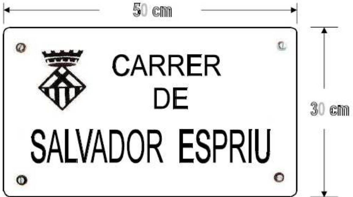
DETALL 1 - Placa de retolament (marbre blanc – gruix de 2 cm)
